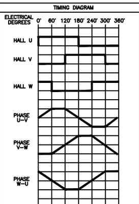
注：电机轴端看为逆时针方向，Z信号在UV反电势的上升沿。
